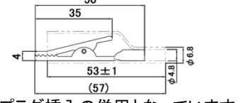
\*特徴:クリップは半田付け、バナナプラグ挿入の併用となっています
