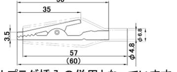
\*特徴:クリップは半田付け、バナナプラグ挿入の併用となっています
