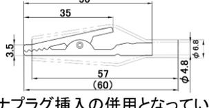
\*特徴:クリップは半田付け、バナナプラグ挿入の併用となっています
