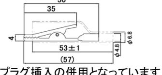
\*特徴:クリップは半田付け、バナナプラグ挿入の併用となっています
