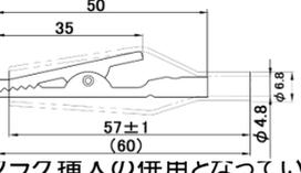
\*特徴:クリップは半田付け、バナナプラグ挿入の併用となっています
