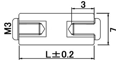
**POM材両端に金属ネジ加工を施し、ネジの締め付けトルクUP!!**
